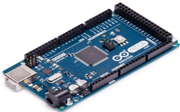
Placa de desarrollo Arduino Mega 2560 (Arduino, 2023)
