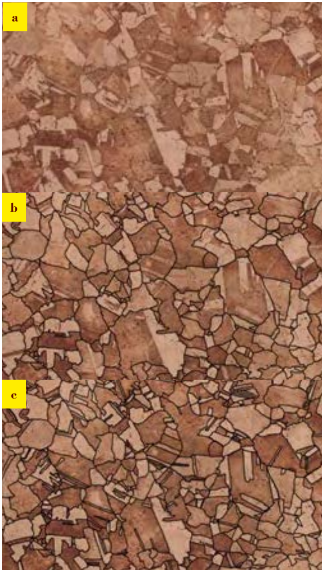
Figura 4. Metalografías del Cu sin ECAP: (a) sólo metalografía; (b) metalografía con las definiciones de límites de granos y subgranos; (c) metalografía con definiciones de límites de granos, subgranos y maclas.
